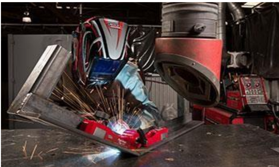
Figura 11. Operadores de soldadura con implementos de seguridad.
