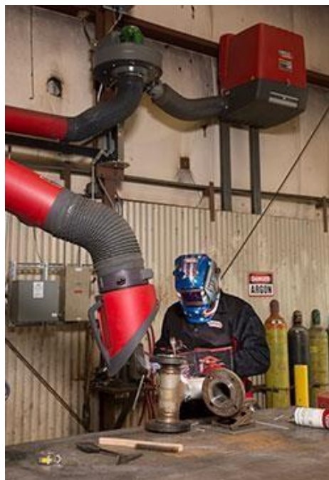
Figura 13. Área de soldadura debidamente ventilado.
