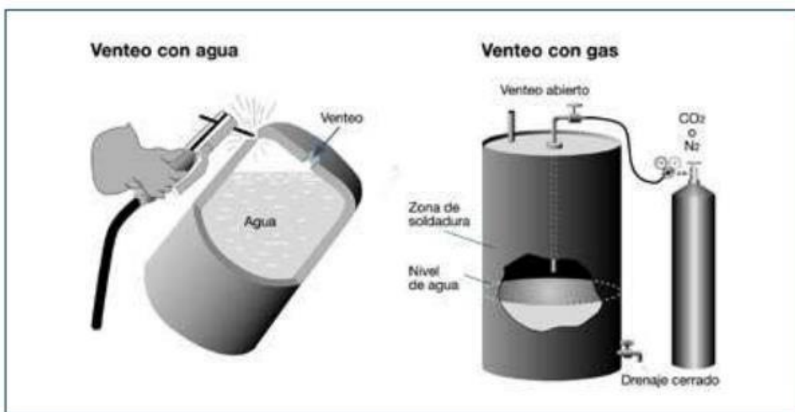
Figura 22. Preparación de estanques para la operación de soldadura.
