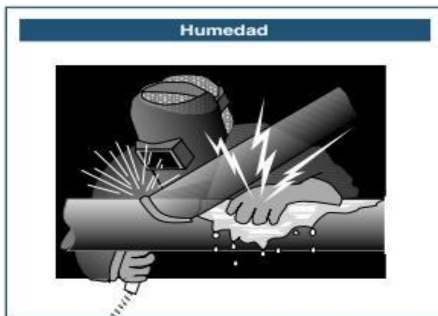
Figura 21. Humedad en el área de soldadura.
