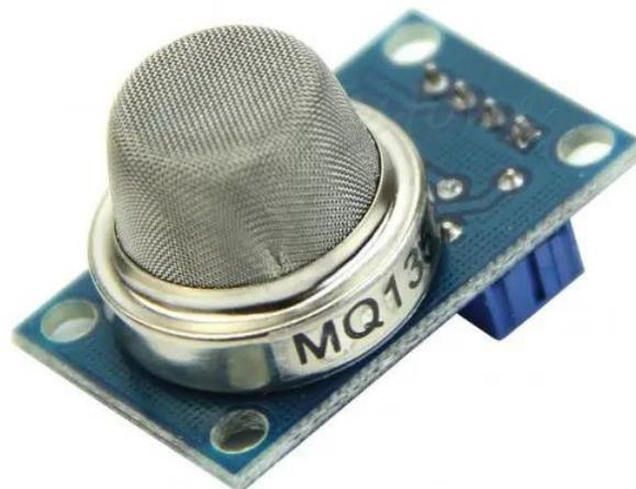
**Figura 2.** “Sensor de calidad del aire MQ-135”
