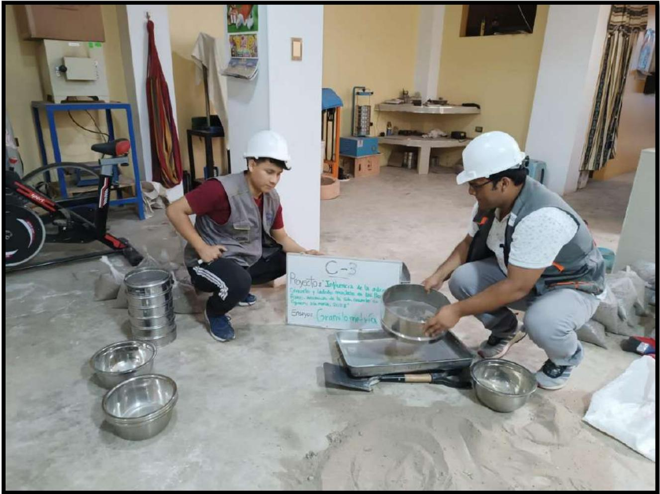
Figura 14. Análisis granulométrico en C-3
