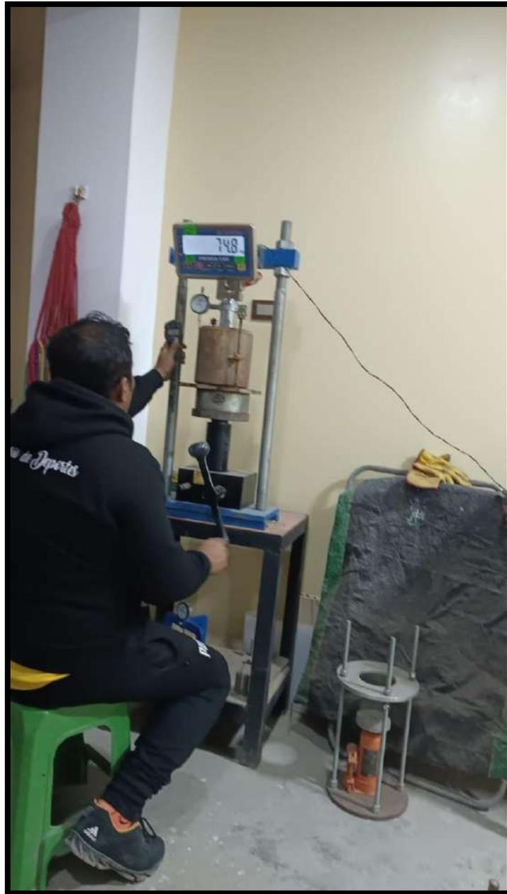
*Figura 19. Ensayo CBR adicionando*
