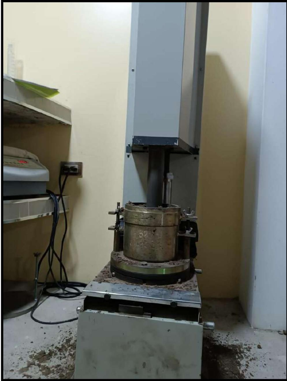
*Figura 16.* Ensayo de Proctor patrón
