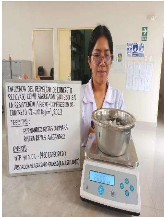
**Foto 09.** Ensayo de peso específico de los agregados
