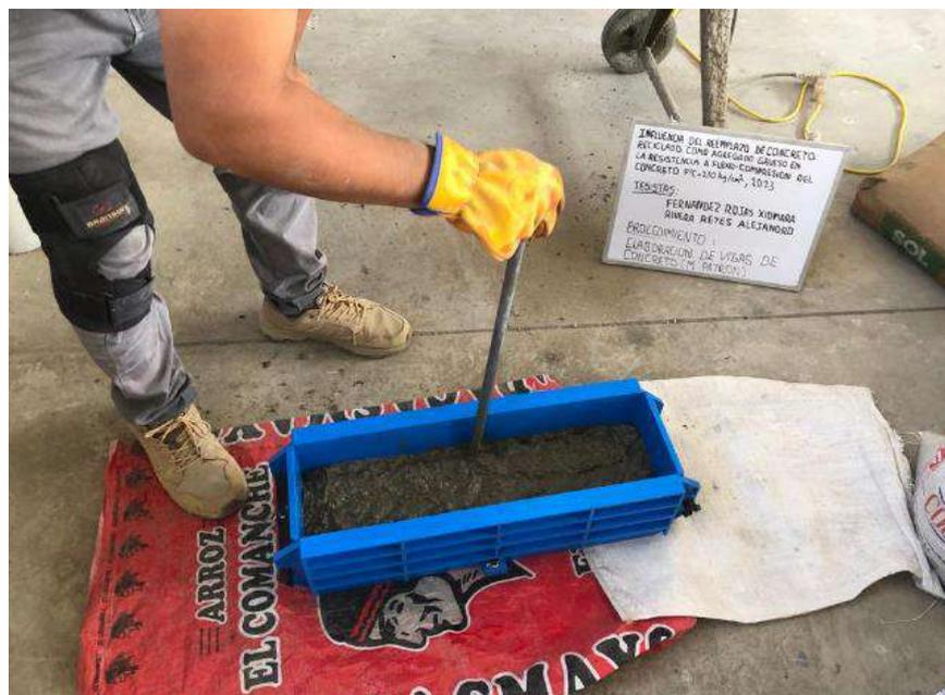
Foto 18. Llenado de concreto patrón y reemplazo
