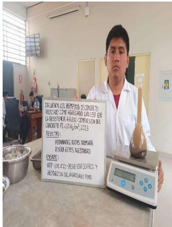
**Foto 08.** Ensayo de absorción de los agregados
