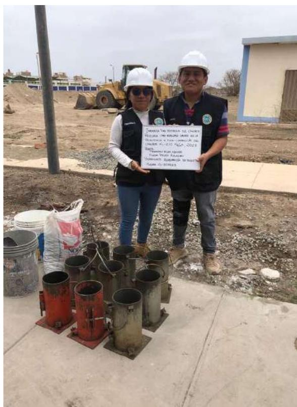
**Foto 12.** Elaboración de probetas tanto para concreto patrón y reemplazo
