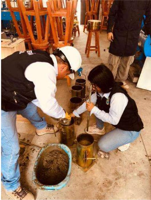
**Foto 13.** Llenado de concreto patrón y reemplazo
