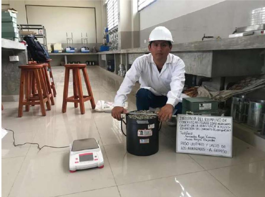
**Foto 07.** Ensayo de peso unitario compactado de los agregados
