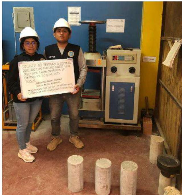
**Foto 16.** Ensayo a compresión de probetas tanto patrón y reemplazo
