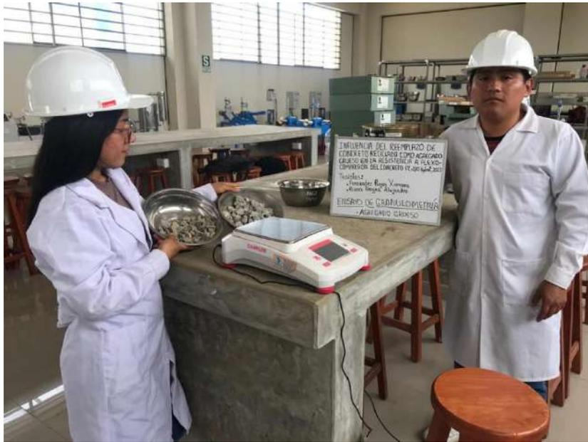
Foto 05. Ensayo de granulometria de los agregados
