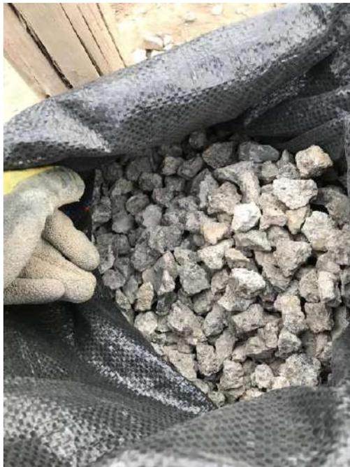
**Foto 04.** Obtención de concreto reciclado, tamaño máximo de 1/2 pulgada
