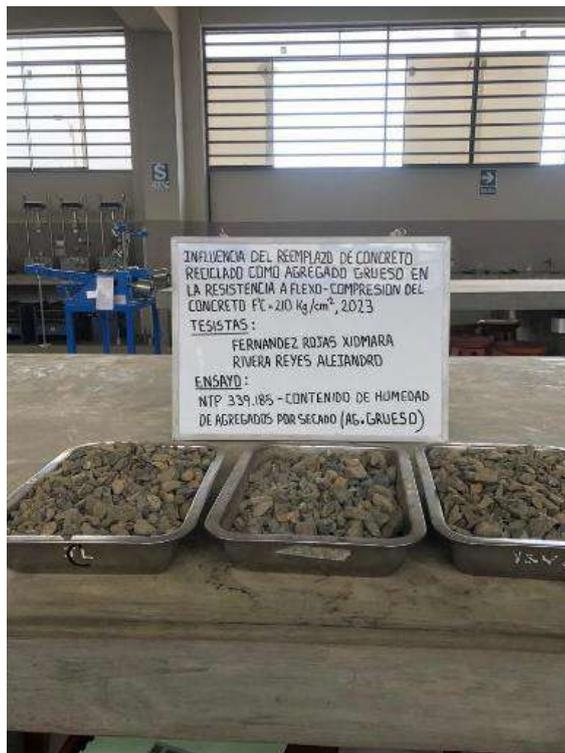
Foto 06. Ensayo de contenido de humedad de los agregados
