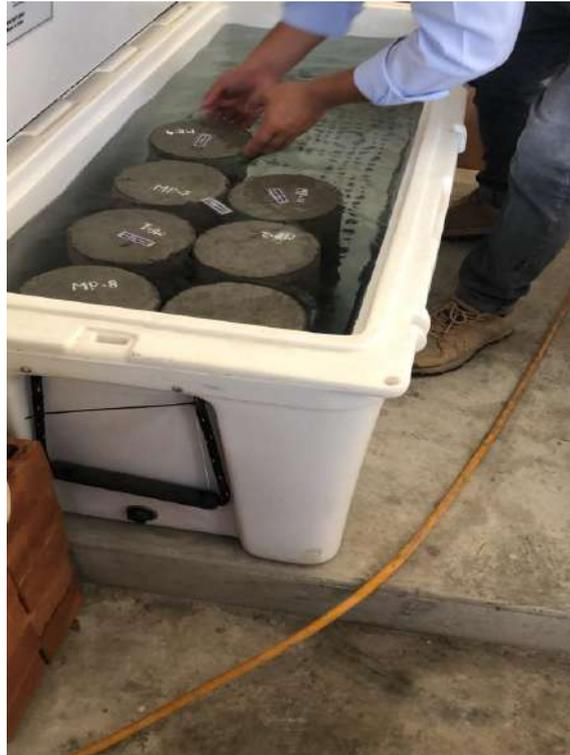
**Foto 15.** Curado de probetas tanto patrón y reemplazo
