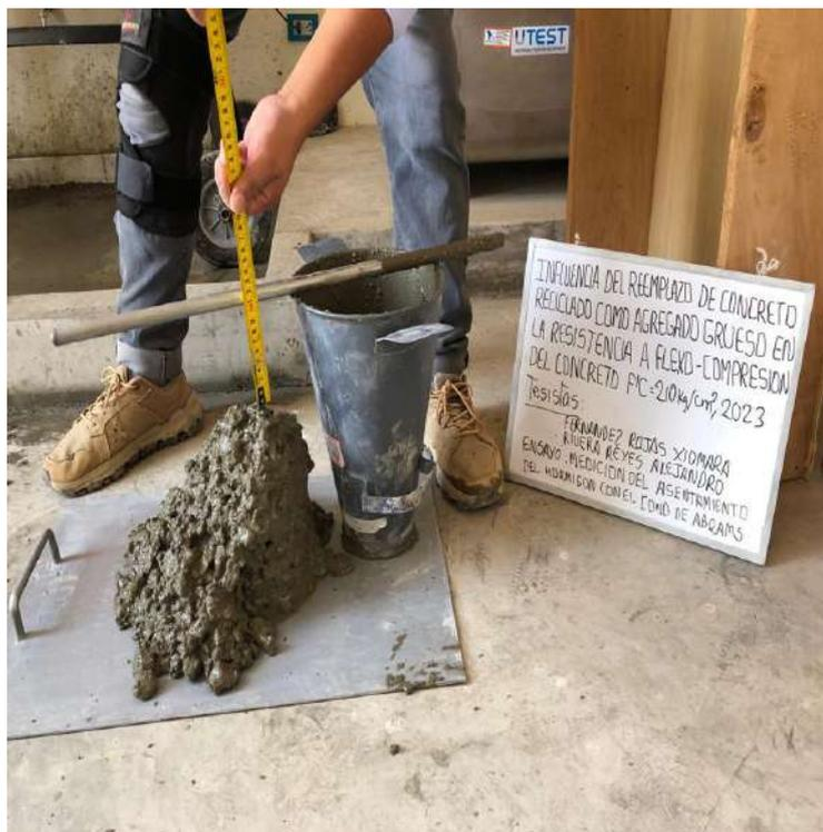
**Foto 11.** Verificación del slump del concreto patrón y reemplazo.
