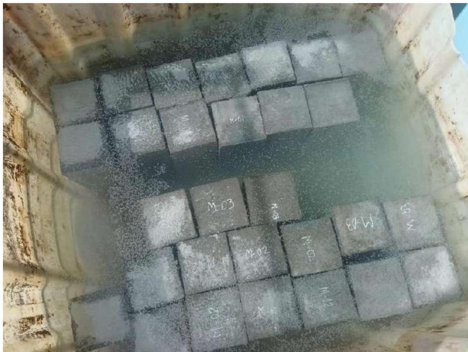
**Foto 20.** Curado de viguetas tanto patrón y reemplazo
