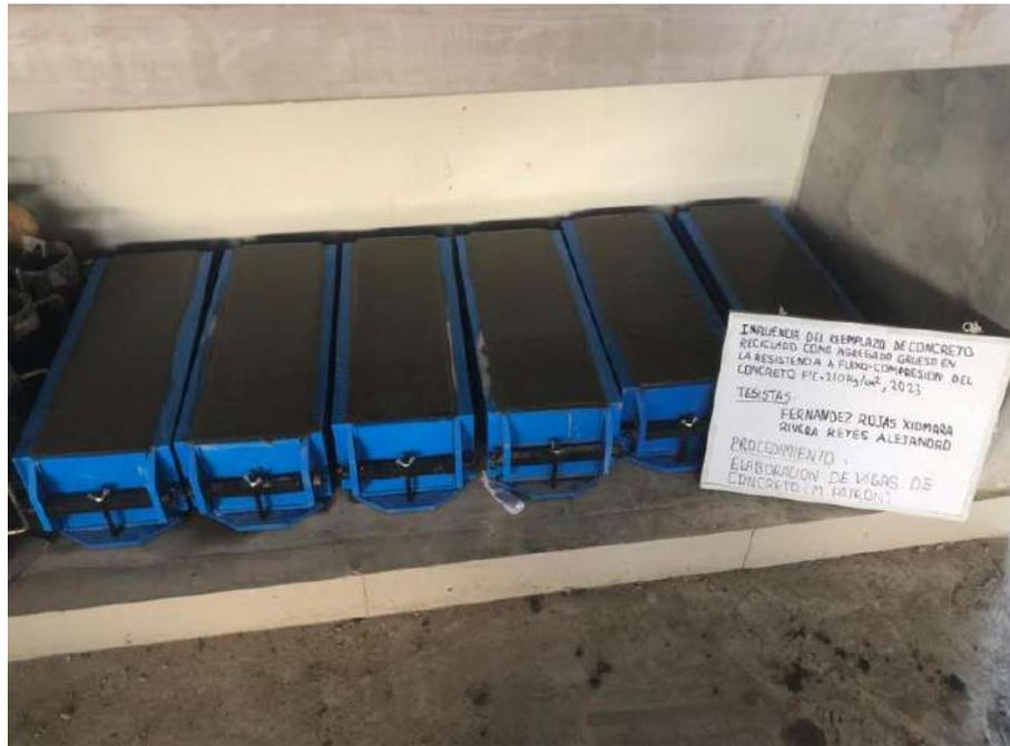
**Foto 19.** Culminación de viguetas tanto patrón y reemplazo
