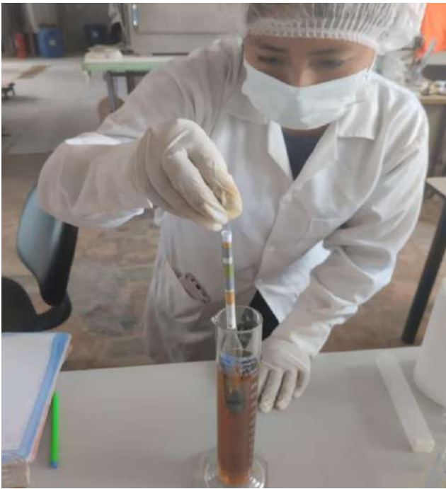
Figura 39: Determinación de densidad de la cerveza
