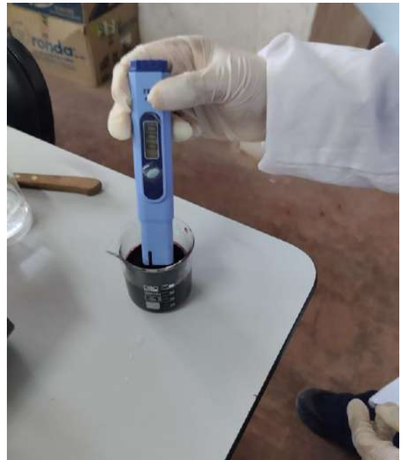
Figura 40: Determinación de los sólidos totales de la cerveza
