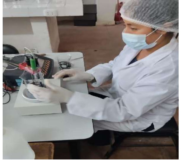
Figura 38: Determinación de pH de la cerveza
