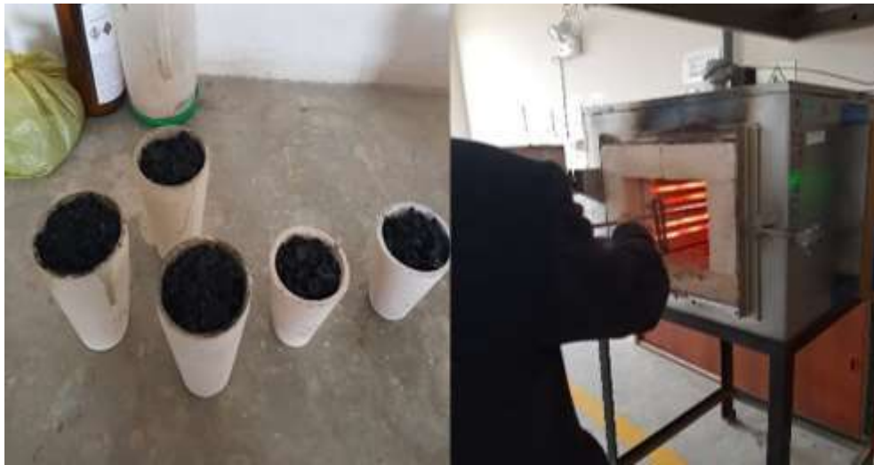
Figura 22 Muestra pre-quemada llevada a la mufla
