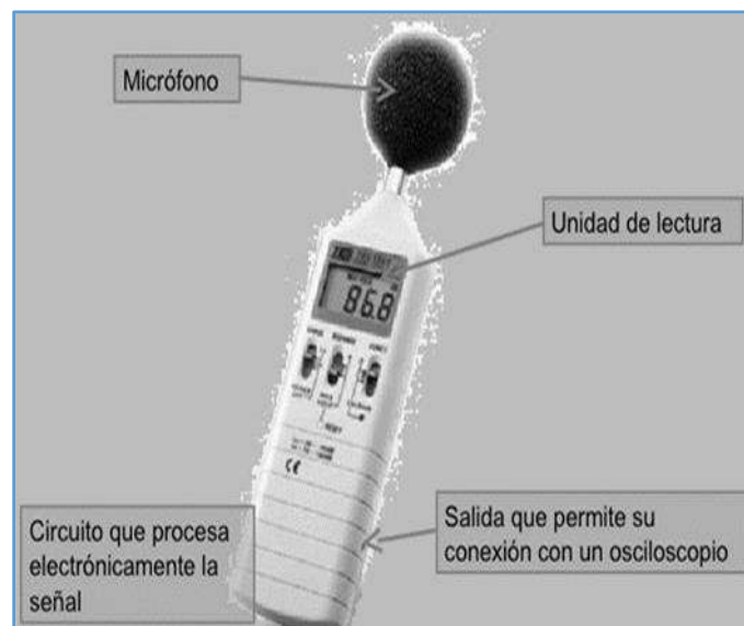
Figura 2. Componentes de un sonómetro
