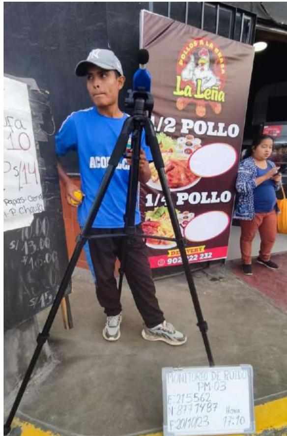
Figura 31: Medición del NPS en la estación PM-03 – Hualmay
