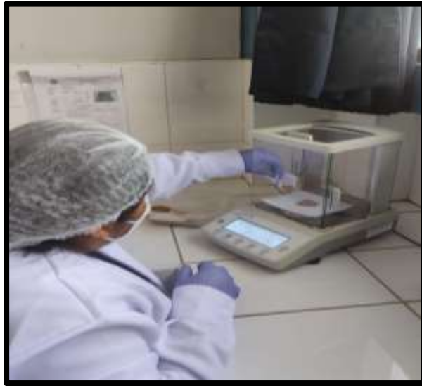
Figura 11. Pesado del coagulante natural en una balanza para realizar el vertido en las diferentes muestras.
