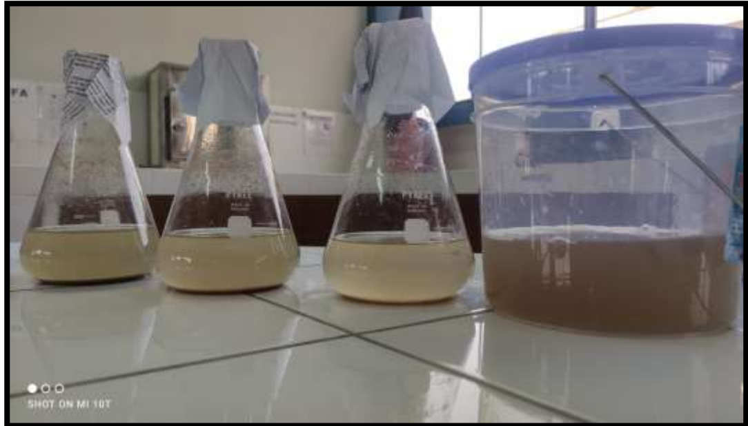
Figura 13. Pruebas de Agua residual con diferentes dosis del coagulante natural de la semilla de Prunus pérsica .
