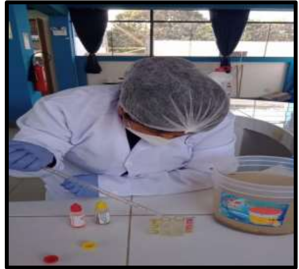
Figura 12. Medición de la turbidez con el colorímetro dentro del laboratorio.
