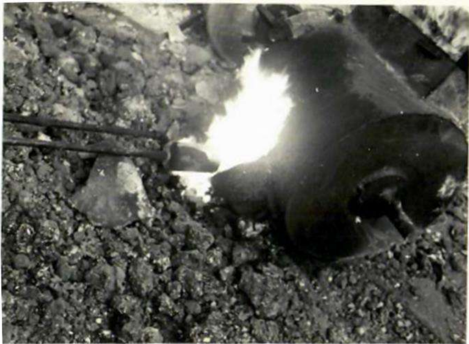
Figura 11. Encendido del reactor.
