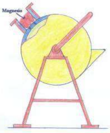
ETAPA 1.-Carga de magnesio en la caja de reacción
