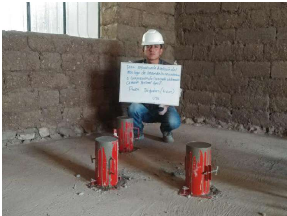
Figura 23: Probetas llenadas a ser desmoldadas a las 24 horas, para posterior curado en agua. Fuente: Autor
