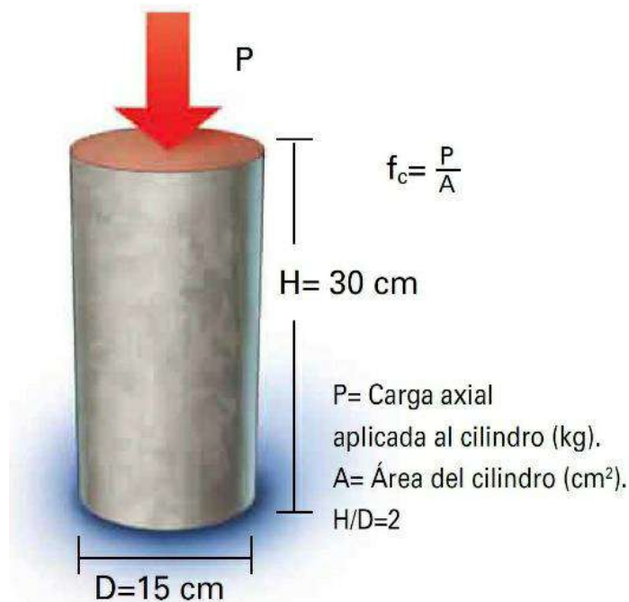
Figura 6: Probeta normalizada, cálculo de la resistencia a la compresión( f_c )
