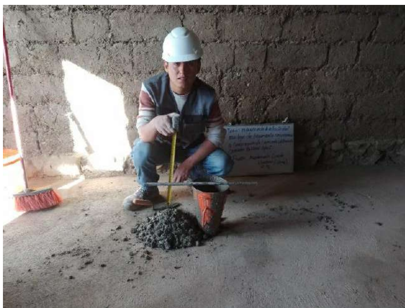
Figura 15: Medición de revenimiento cono de Abrams Fuente: Autor
