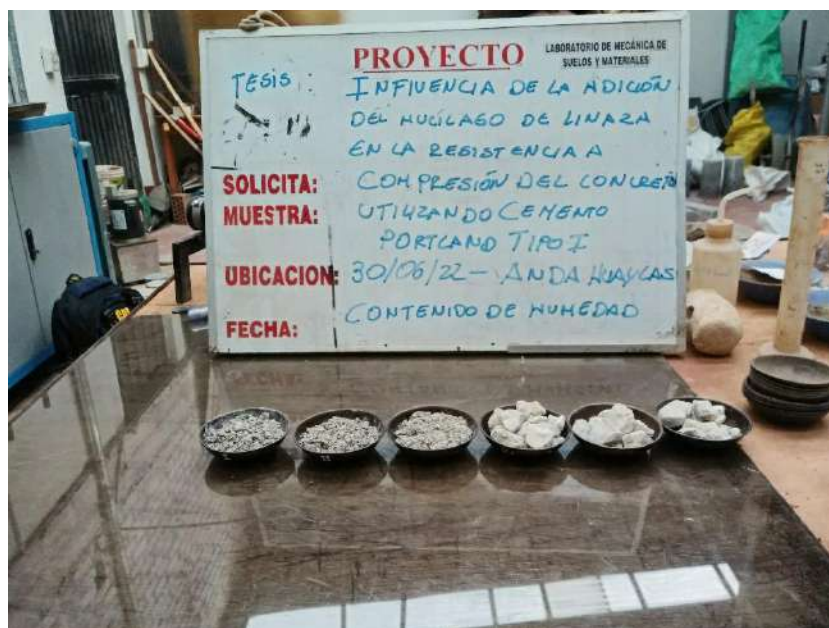
Figura 9: Muestras posterior al proceso de secado en el horno con el fin de calcular el contenido de humedad. Fuente: elaborado por el autor.
