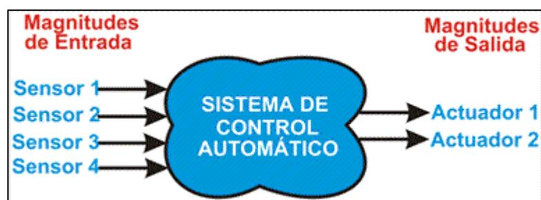
**Figura N° 05: Elementos de un sistema de control**
