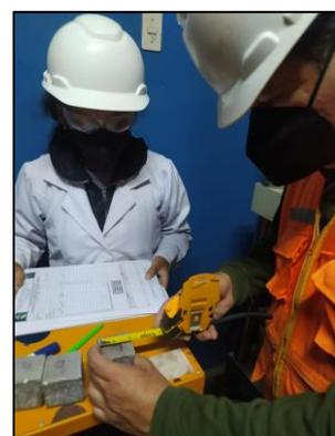
Fotografía 10, 11, 12 y 13: Medición de dados de mortero convencional y modificado al 5%, 7% y 9%
