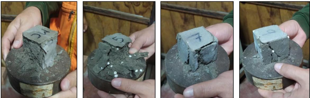
Fotografía 15, 16, 17 y 18: Muestra de dados de morteros convencional y modificados al 5%, 7% y 9% post compresión.
