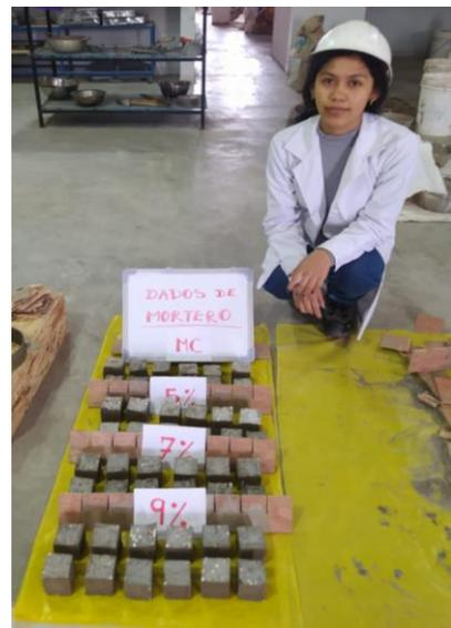
Fotografía 08 y 09: Dados de mortero convencional y mortero con incorporación del 5%, 7% y 9% de perlas de poliestireno
