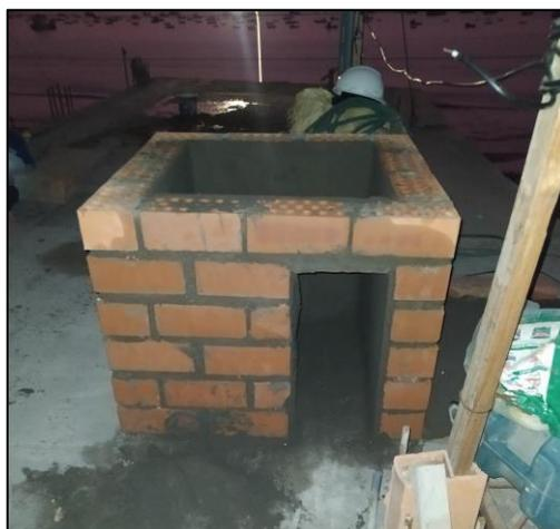
Fotografía 24: Prototipo Convencional – revestido con mortero 1:4
