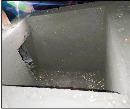
Fotografía 25: Prototipo Modificado - Revestimiento con mortero modificado (9%)
