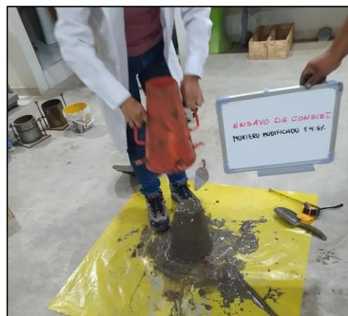
Fotografía 04 y 05: Ensayo de Consistencia con el cono de Abrams (Laboratorio Jonelta S.A.C.)
