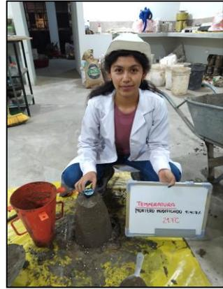
Fotografía 06 y 07: Medición de Temperatura al mortero convencional y modificado (Laboratorio Jonelta S.A.C.)
