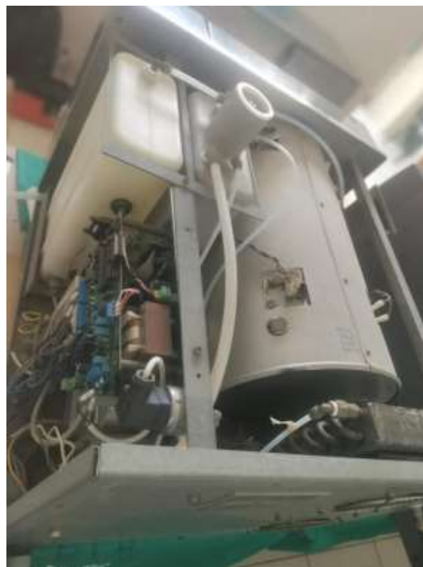
Figura 7. Mantenimiento interno de la autoclave de mesa CISA
