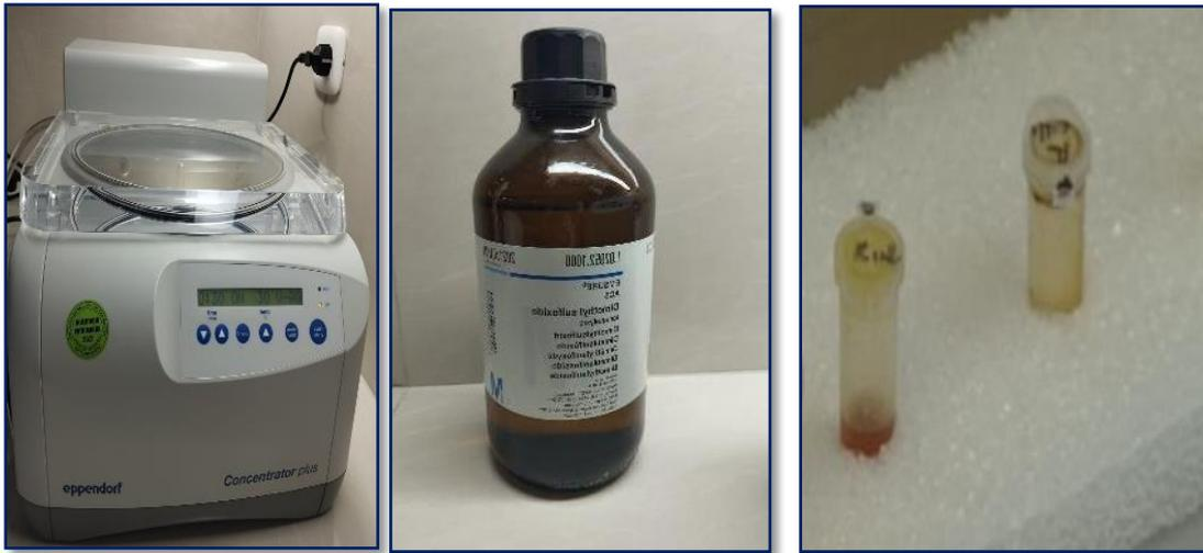
**Figura 10.** Concentrador para concentrar nuestra muestra y favorecer la evaporación del solvente. La muestra resuspendida con 2mL de DMSO obteniendo así nuestra solución al 100%.
