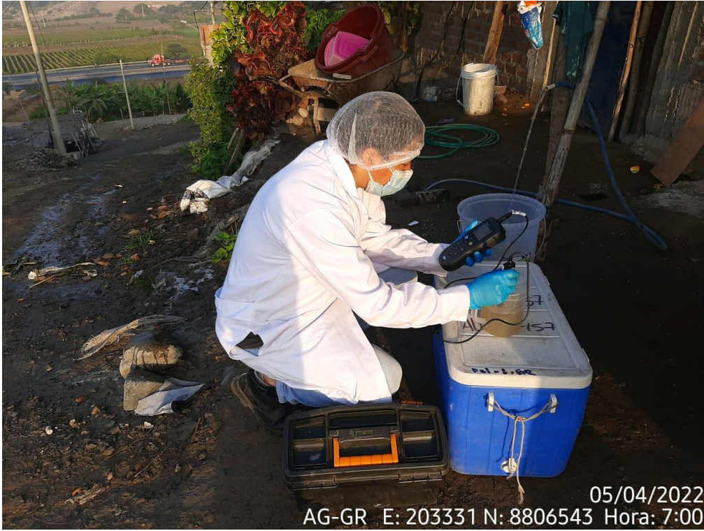
Figura 28: Muestreo de parámetros en situ de la estación AG-GR
