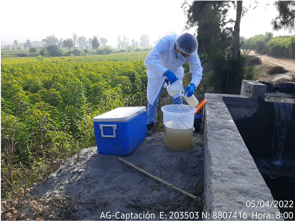
Figura 43: Toma de muestra de parámetros fisicoquímicos y microbiológicos de la estación AG-Captación.
