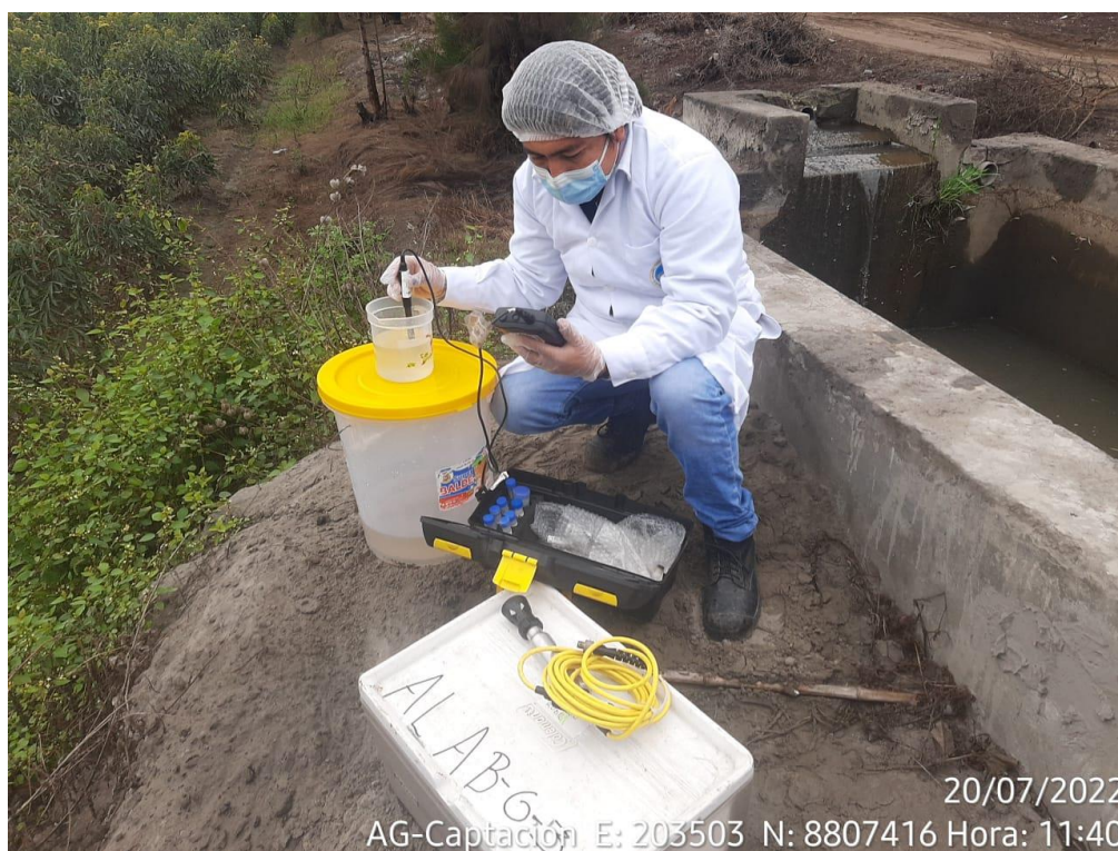
Figura 50: Muestreo de parámetro in situ de la estación AG-Captación del mes de julio
