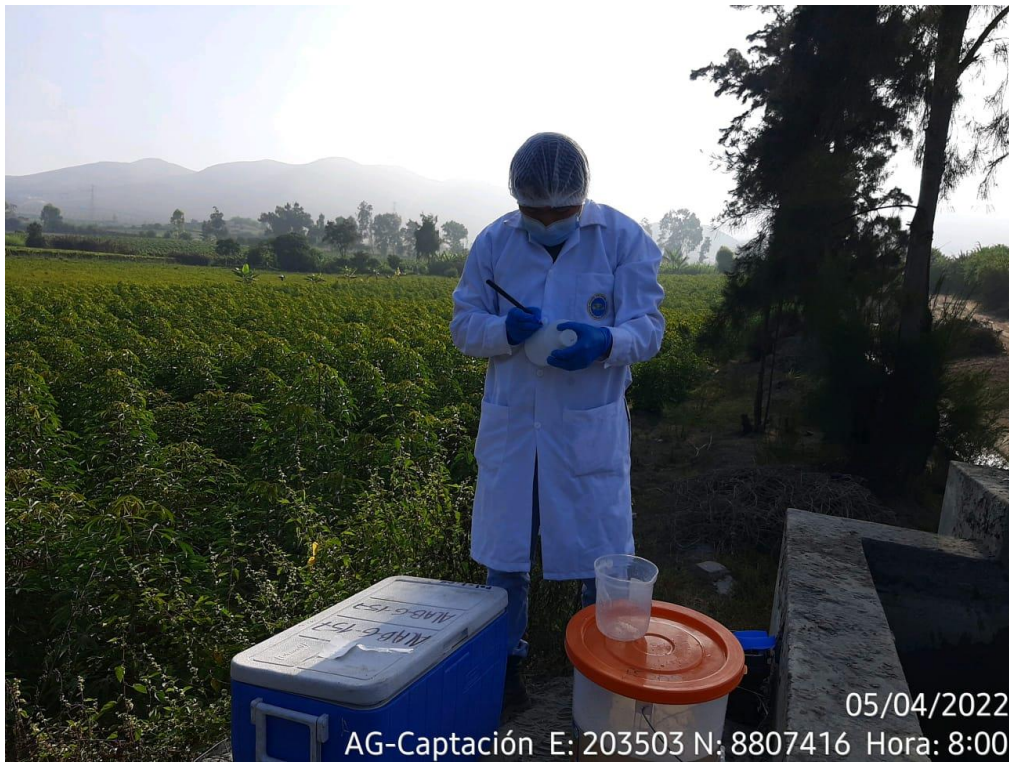
Figura 3: Rotulado de los frascos para la toma de muestra
