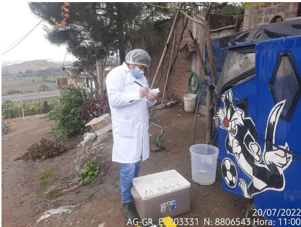
Figura 45: Rotulado de los frascos para la toma de muestra de la estación AG-GR del mes de julio
