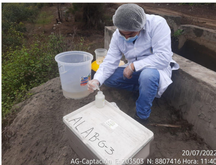
Figura 52: Preservación de las muestras de la estación AG-Captación del mes de julio
