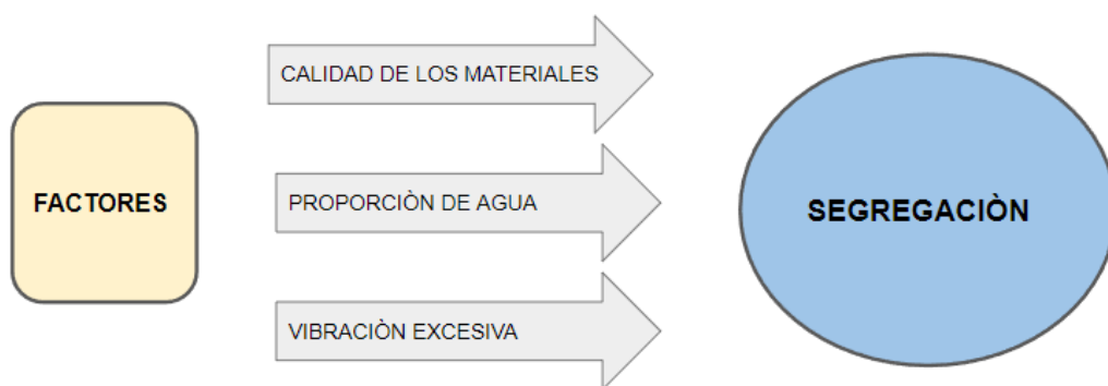
Figura 9 Diagrama de los factores de la segregación del concreto 2022.
