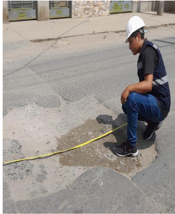
Fotografía 13 Identificación y medición de tipo de falla hueco, nivel de severidad alto.
