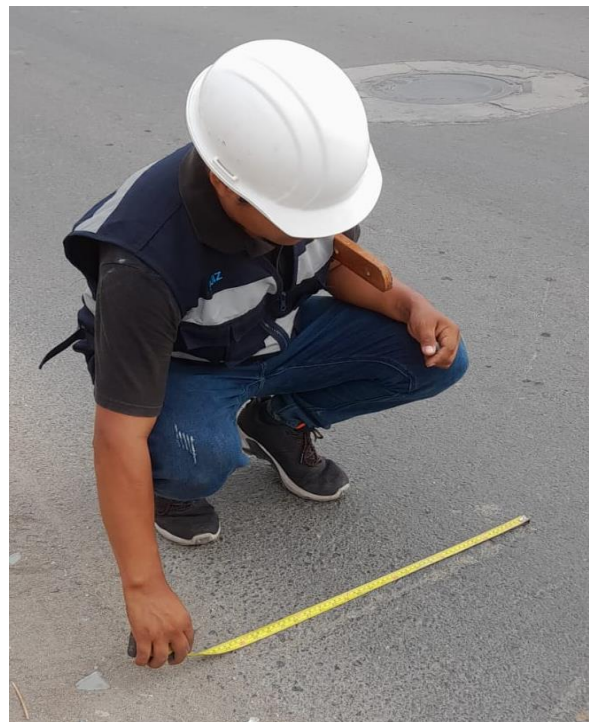
Fotografía 16 Identificación y medición de tipo de falla grietas longitudinales y transversales.
