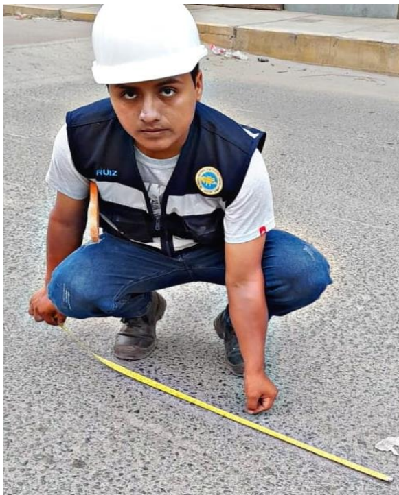
Fotografía 16 Identificación y medición de tipo de falla grietas longitudinales y transversales.
