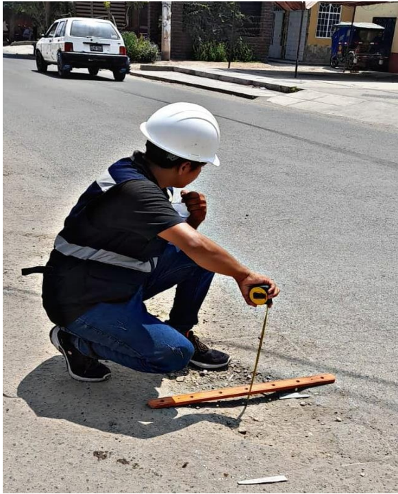
Fotografía 13 Identificación y medición de tipo de falla hueco, nivel de severidad alto.
