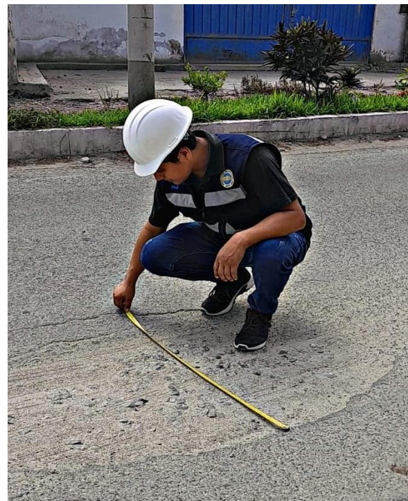
Fotografía 12 Identificación y medición de tipo de falla hueco, nivel de severidad alto y medio.
