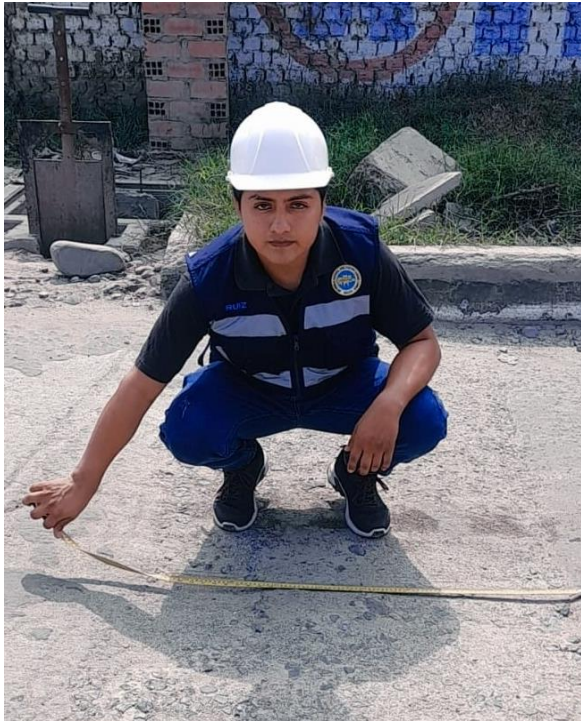
Fotografía 11 Identificación y medición de tipo de falla parcheo, nivel de severidad alto.
