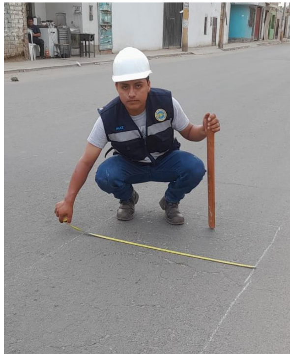
Fotografía 2 identificación y medición del tipo de falla parcheo, nivel de severidad alto y bajo.
