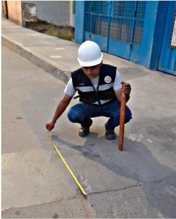
Fotografía 7 Identificación y medición de tipo de falla parcheo, nivel de severidad bajo y alto.
