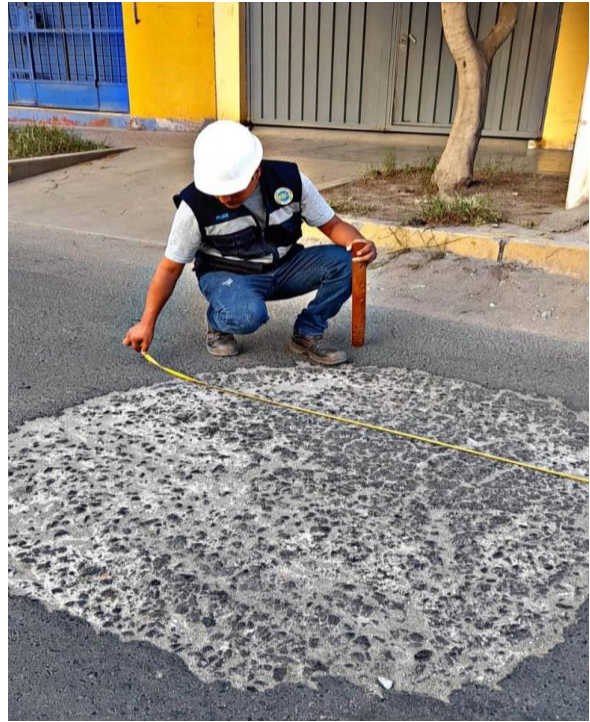
Fotografía 7 Identificación y medición de tipo de falla parcheo, nivel de severidad bajo y alto.
