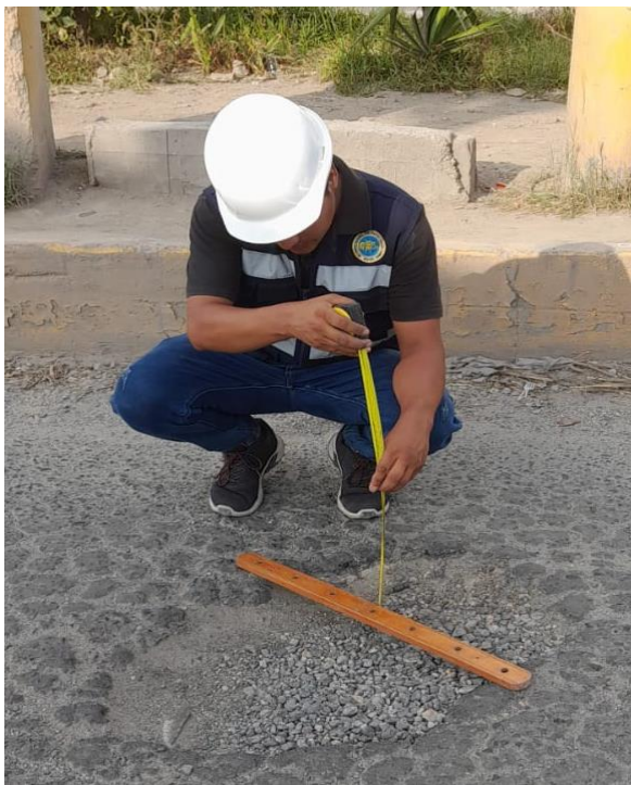
Fotografía 12 Identificación y medición de tipo de falla hueco, nivel de severidad alto y medio.
