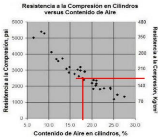
Gráfico de la Resistencia a la Compresión versus Contenido de Aire en Especímenes de Concreto Pemeable.
