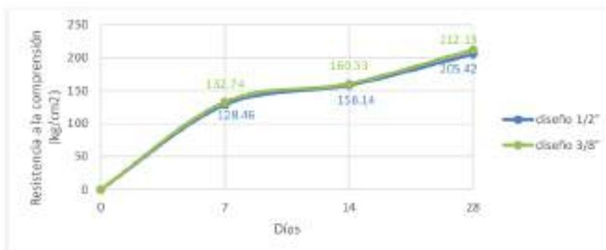
Nota: Resultados de los ensayos de resistencia a compresión muestran que el diseño de 3/8" presenta mayor resistencia
