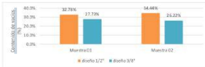
Nota: Se puede observar en la gráfica que el concreto poroso realizado con agregado de 1/2" resulto más poroso en las dos muestras realizadas.
