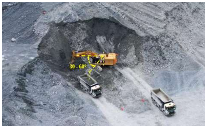
Figura 36. Ángulo de giro de la excavadora en el carguío.
