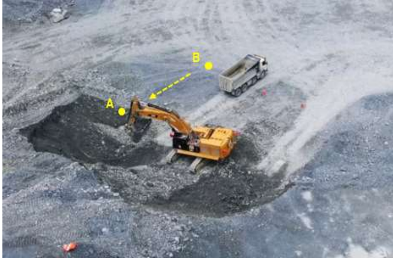
Figura 54. Ingreso del volquete en retroceso al carguío.
