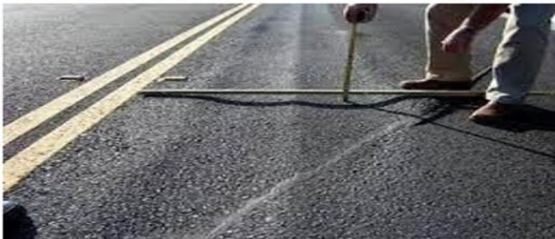
Nota: Las deformaciones verticales (ahuellamiento) en un pavimento generalmente se produce por la deformacion de las bases
