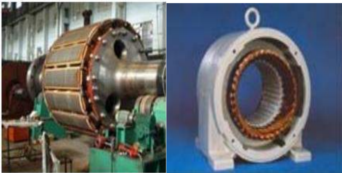
Figura 03. Imagen del estator y rotor del generador síncrono.
