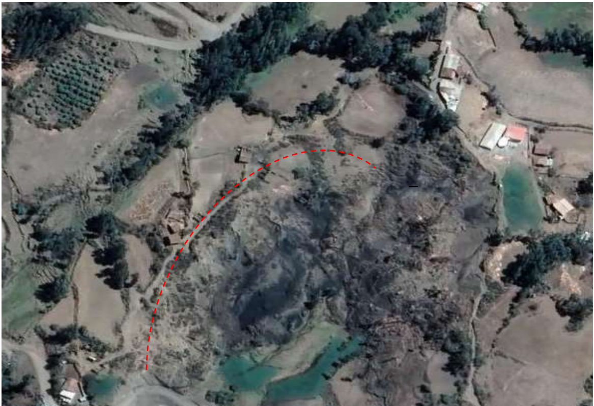
Figura 23. Vista panorámica del escarpe principal del deslizamiento 2 (DES-2).
