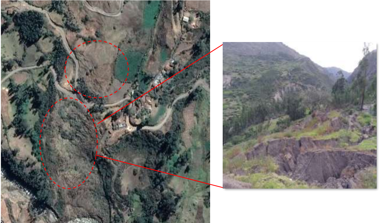
Figura 22. Vista panorámica de las grietas originadas por la activación del deslizamiento 2 (DES 2)
