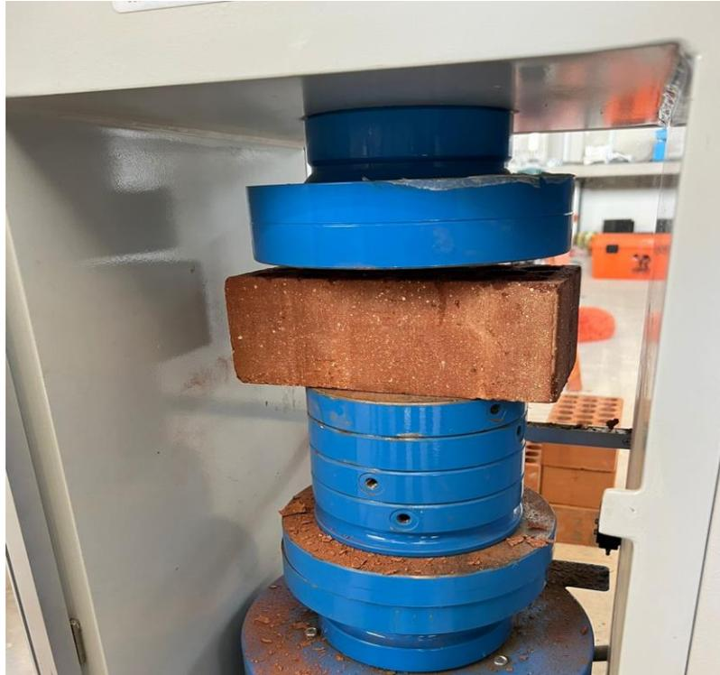
**FOTO 1: ANALIZANDO LA RESISTENCIA A LA COMPRESIÓN**
