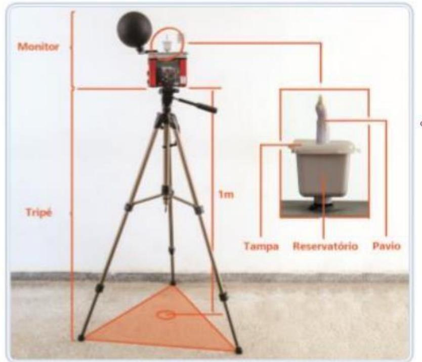
Figura 17. Monitor en el trípode y depósito de agua destilada
