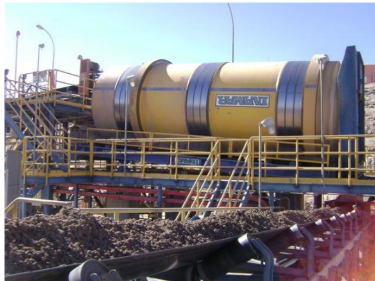
Figura 25. Equipo de Aglomeración en tambor rotatorio.
