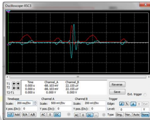
Figura 20. Señal ecg filtrada para el detector de QRS
