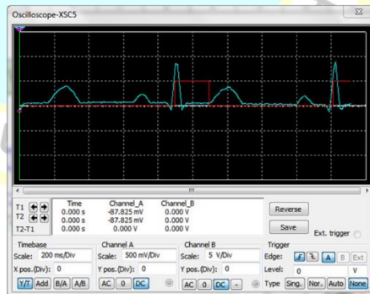
Figura 29. Pulsos generados por el monoestable y señal ECG
