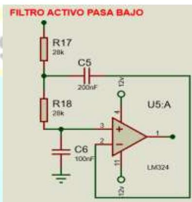
Figura 46: Esquema del filtro activo pasa bajo
