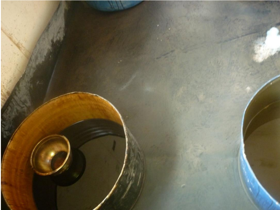
Figura 38. Recipientes con hidrocarburo sobre la bandeja de contención.
