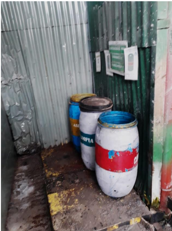
Figura 46. Capacitación al personal almacenero de que cada recinto de producto químico debe tener el Kit Antiderrame, Arena fina limpia y Aserrín limpio.
