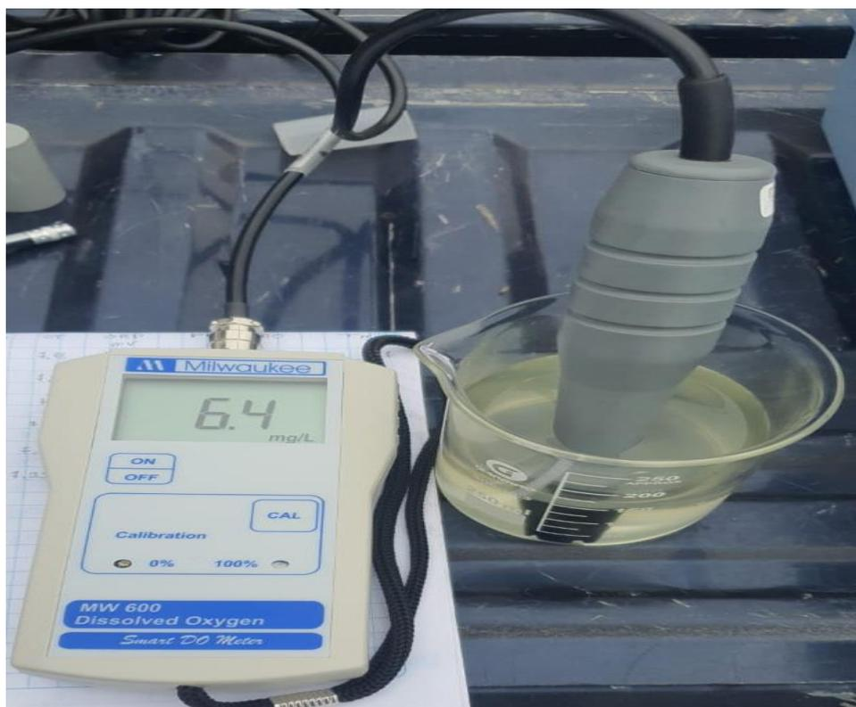
*Figura 4.* Medición del parámetro de oxígeno disuelto.
