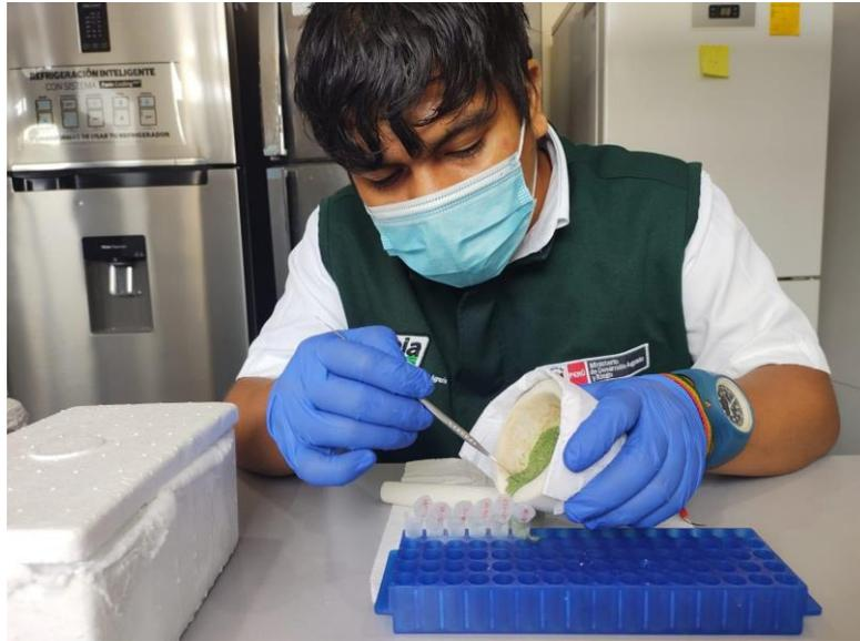
**Figura 5.** Molienda del tejido vegetal con nitrógeno líquido.
