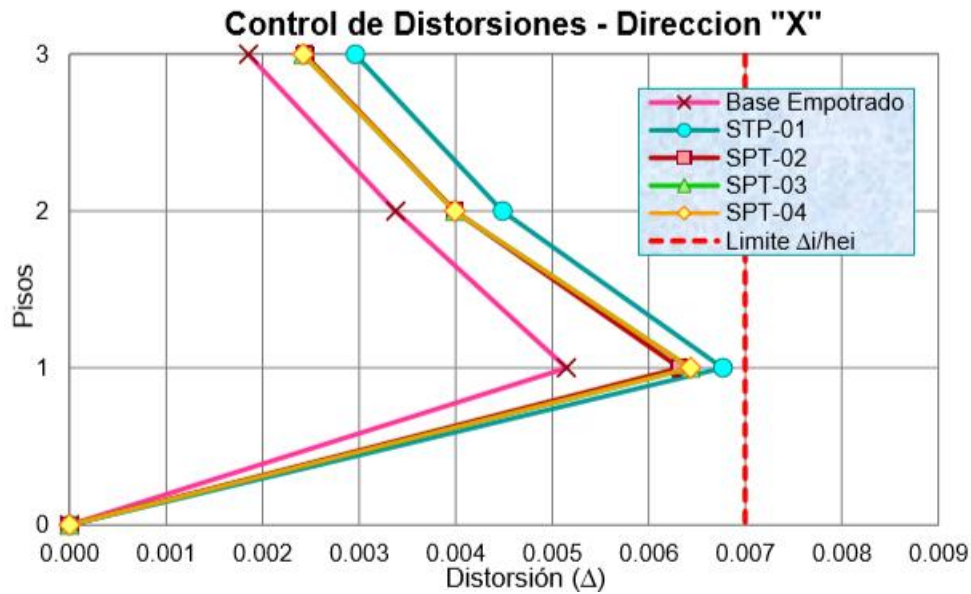
Figura 69. Derivas entre piso eje x– 3 pisos
