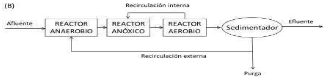
Figura 6. Proceso de eliminación biológica de materia orgánica, nitrógeno y fósforo (Buitrón y col., p. 14)
