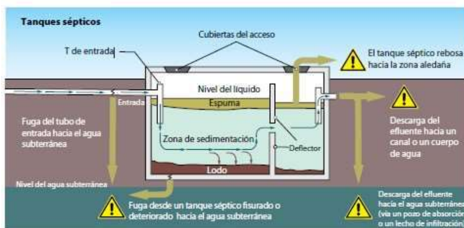
Figura 2. Esquema de una contención impermeable y permeable (fuente: Guías para el saneamiento y la salud OMS, 2019, p.35)
