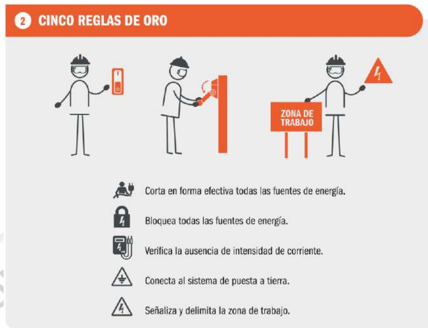
Figura 3. Reglas antes de realizar trabajos con electricidad.
