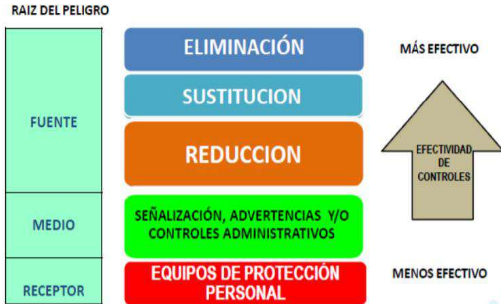
Figura 3. Jerarquización de riesgos.
