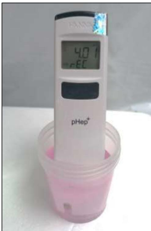
Figura 28. Calibración automática del tester de pH y Temperatura.
