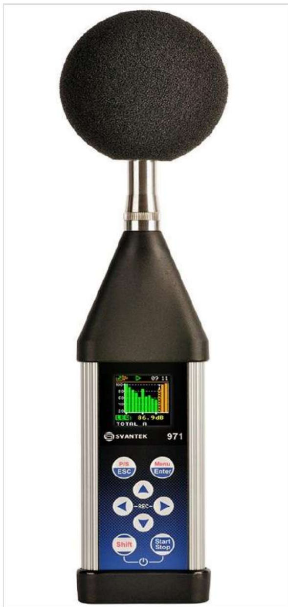
Figura 21. Sonómetro SVAN 971-Clase I (Fuente: Tech Perú Industrial S. A. C-Sonómetros, 2021).
