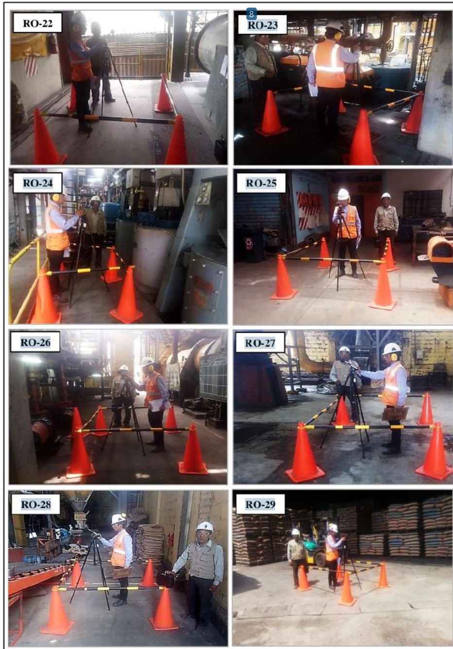
Figura 25. Medición del ruido ocupacional en el departamento de elaboración (Parte II). Fuente: Autoría propia.
