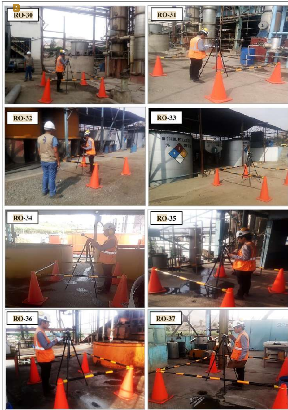
Figura 26. Medición del ruido ocupacional en el departamento de destilería. Fuente: Autoría propia.
