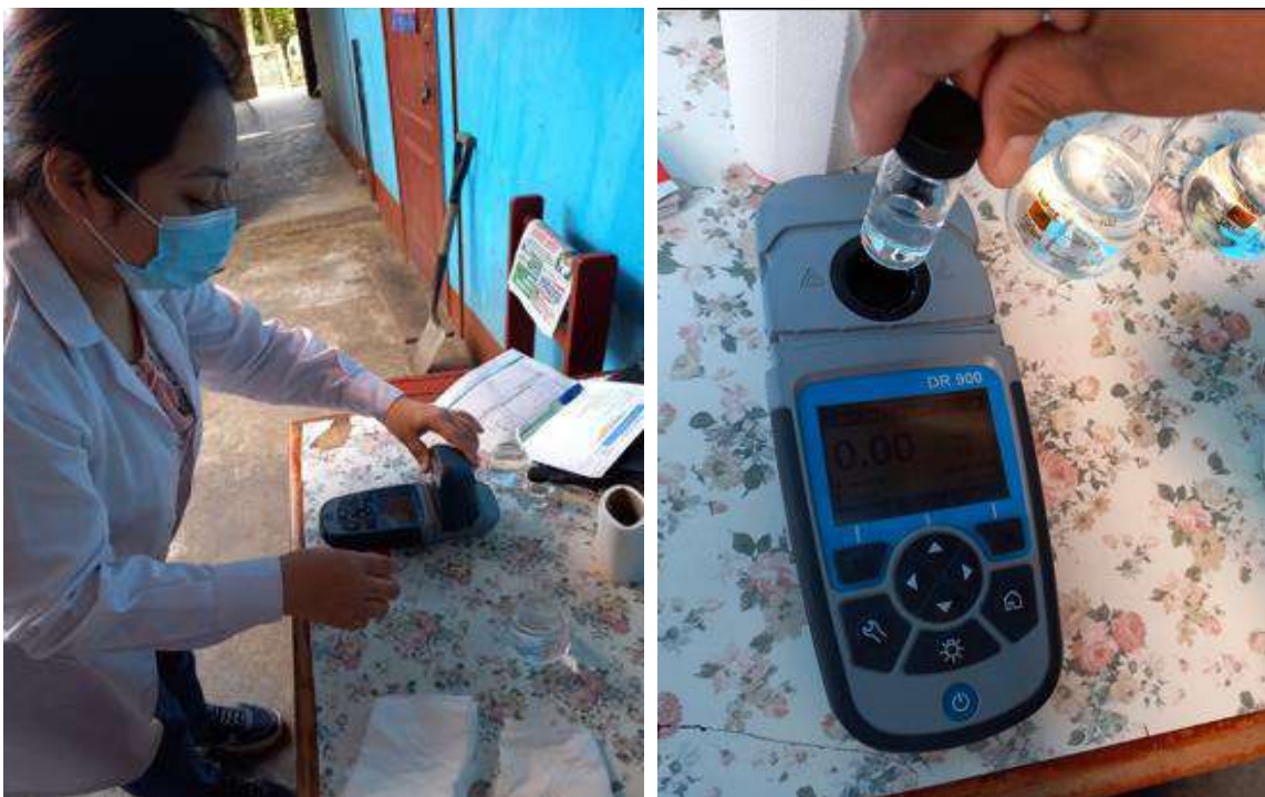
Figura 17. Calibración del equipo Colorímetro portátil DR900
