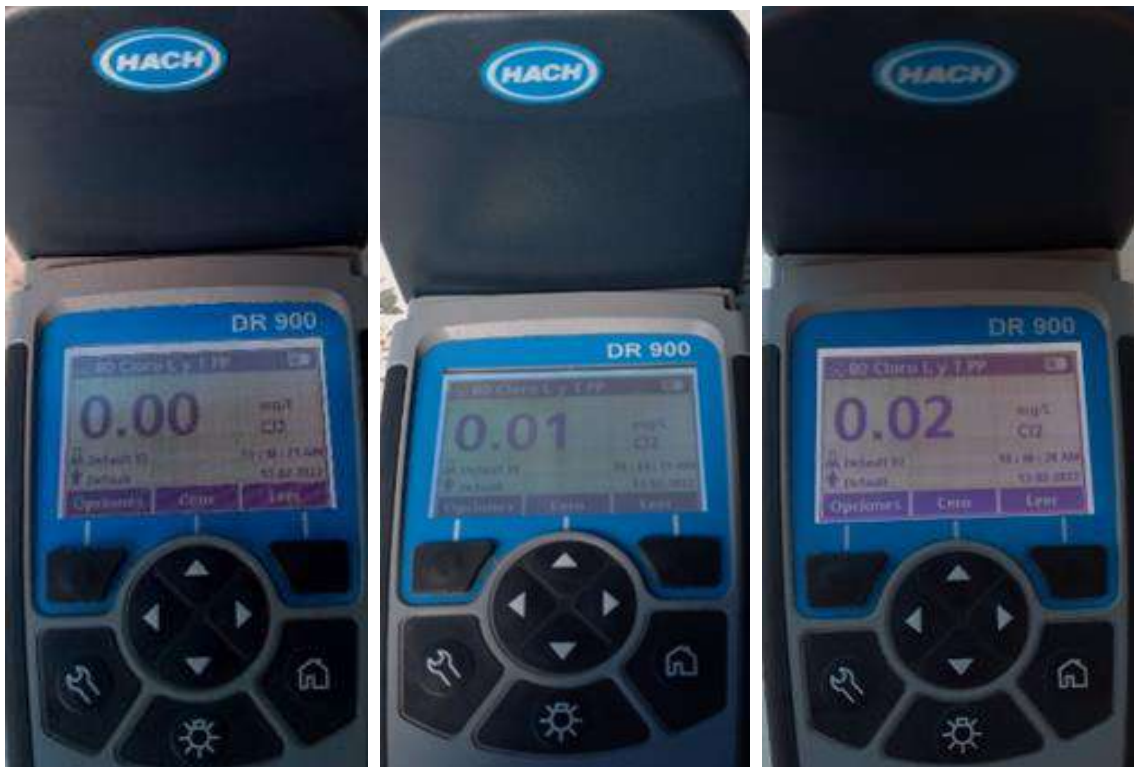
Figura 18. Evidencia de resultado de cloro residual en distintos domicilios
