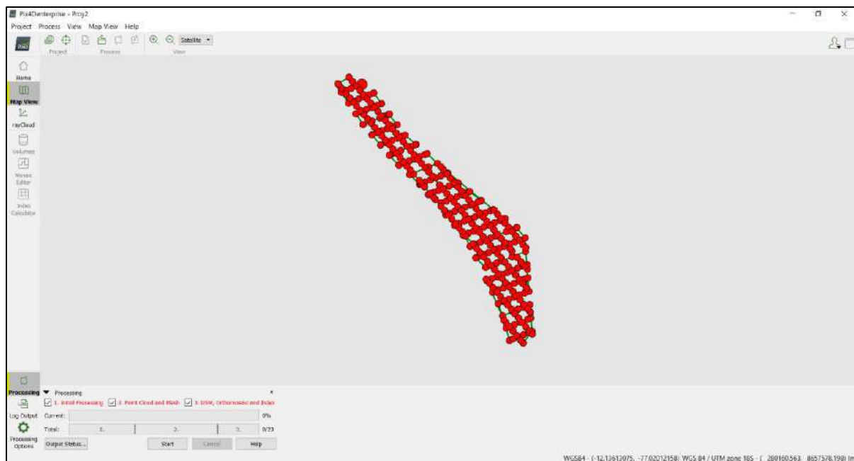
Figura 91: Se muestra las posiciones de las fotos que tomo el dron en su plan de vuelo. Fuente: Elaboración propia.
