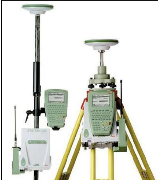
Figura 10: Equipos utilizados para las actividades de campo GPS Rover y Receptora Leica Pertenciente a la serie 1200. Fuente: Leica Geosystem
