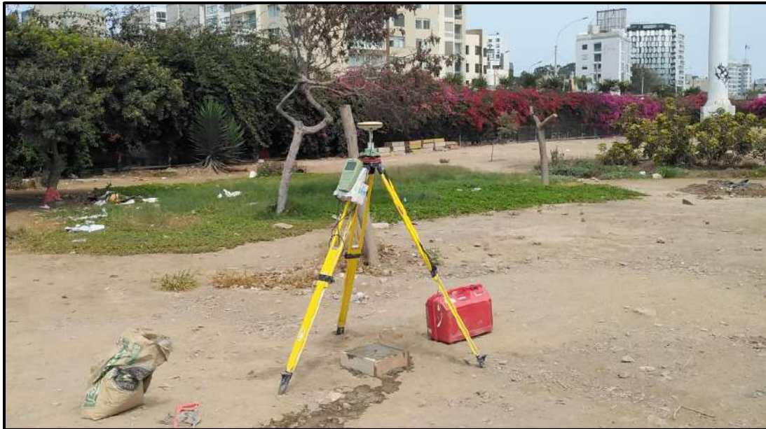
Figura 12: Medición de monumento FLO-001. Fuente: Elaboración propia
