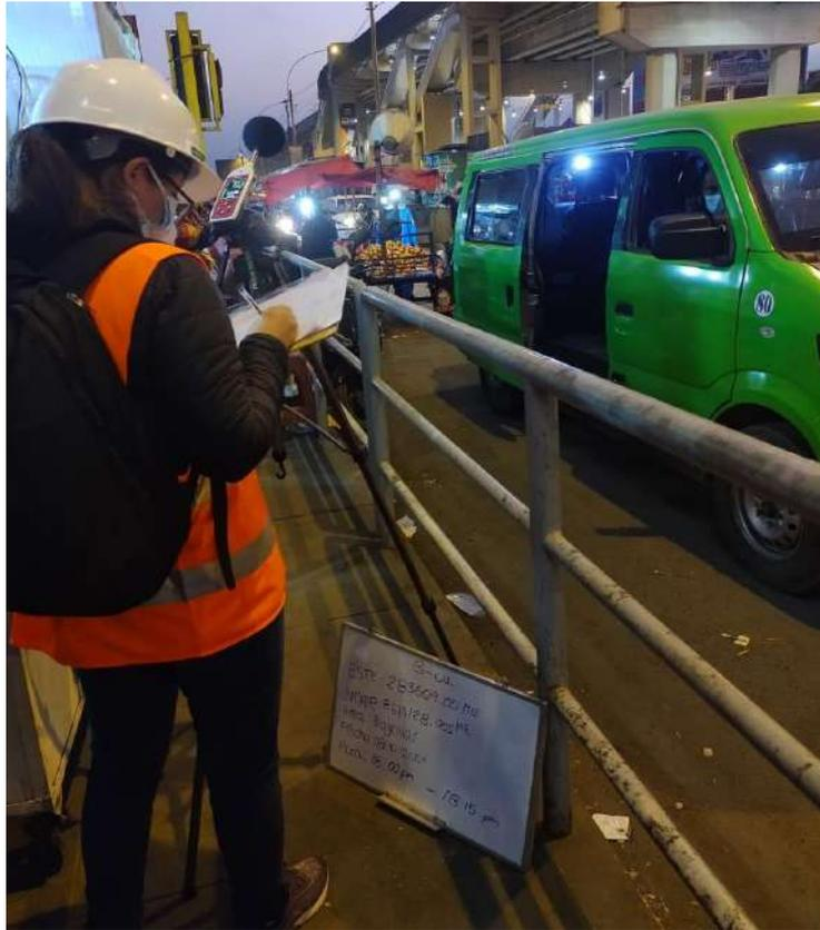
Figura 32. Medición De Ruido En Bayóvar 08/10/2021
