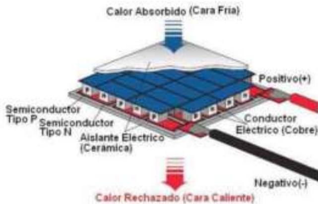
Figura 1. Estructura de una celda Peltier.
