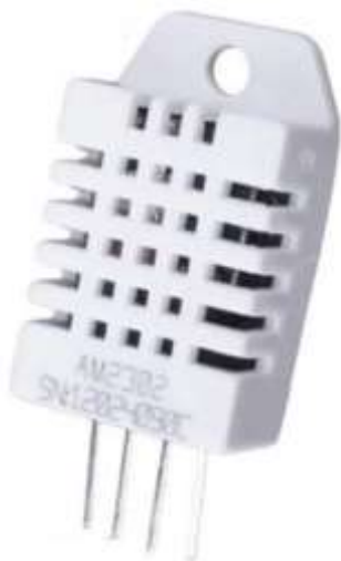
Figura 7. Características del sensor DHT22.
