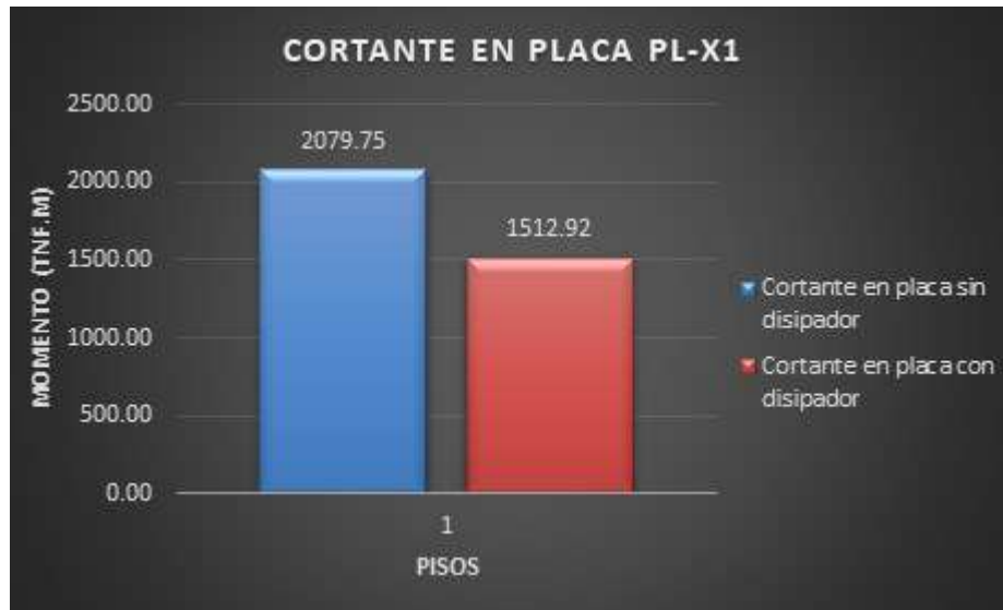
Figura 117. Fuerza cortante en los muros estructurales PL-X1 del edificio sin disipadores vs edificio con disipadores
