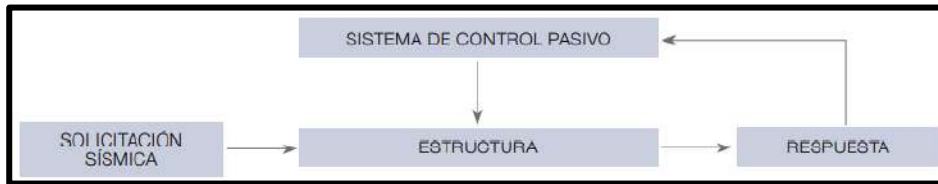
Figura 17. Esquema de mecanismo de operación de sistemas pasivos
