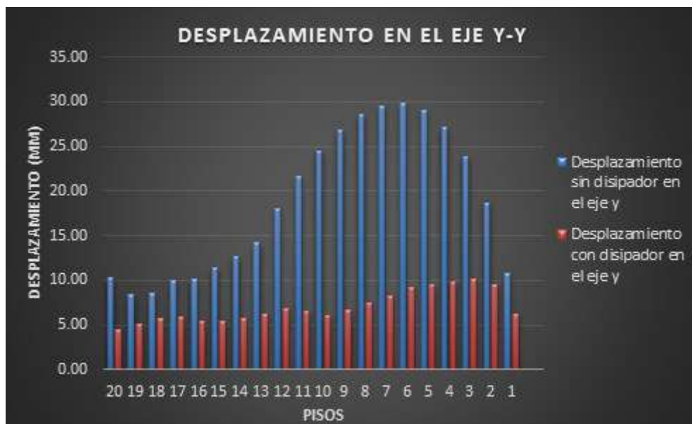
Figura 105. Desplazamiento del edificio sin disipadores vs edificio con disipadores en el eje y-y
