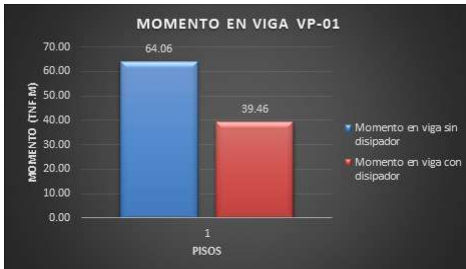
Figura 114. Momento flector en la viga VP-01 del edificio sin disipadores vs edificio con disipadores
