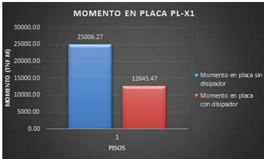
Figura 116. Momento flector en los muros estructurales PL-X1 del edificio sin disipadores vs edificio con disipadores
