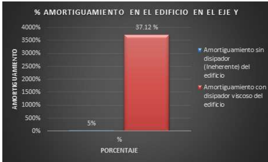
Figura 111. Amortiguamiento inherente del edificio vs viscoso de los disipadores en el eje y-y
