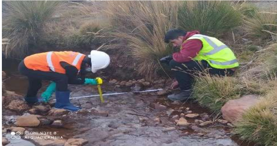
Figura 18. Se realiza la medida de profundidad para determinar área del cauce del río.
