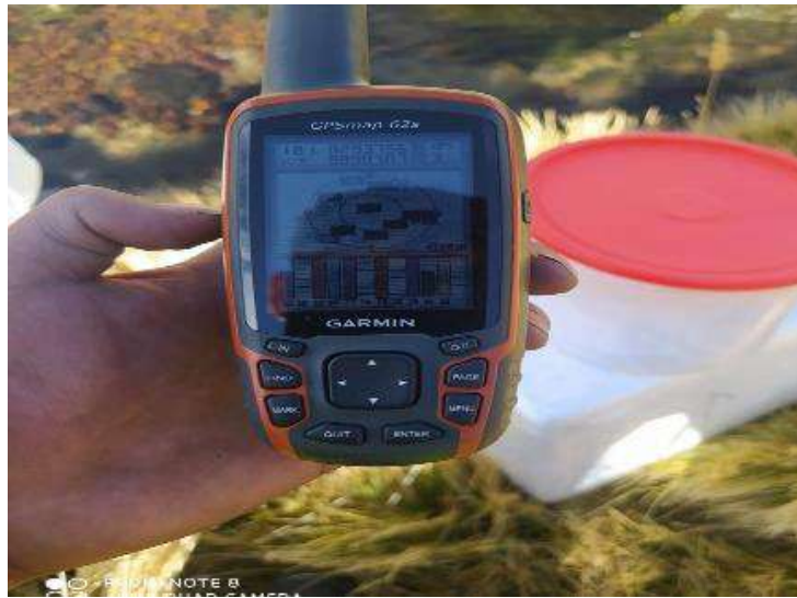
Figura 19. Se utilizó un equipo GPS para la determinación de coordenadas de los puntos de muestreo
