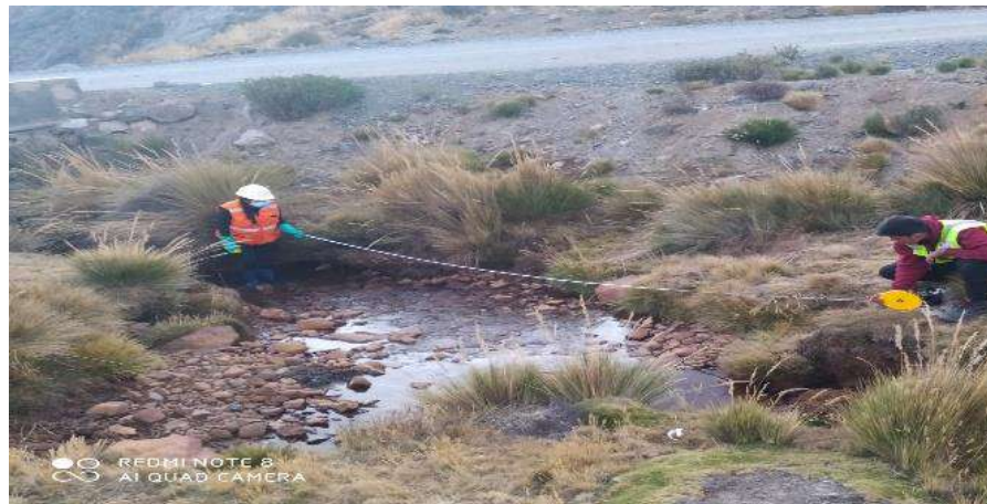
Figura 17. Mediciones cada 10 metros para determinar el Caudal del río Chanquillo, empleando el método de flotador
