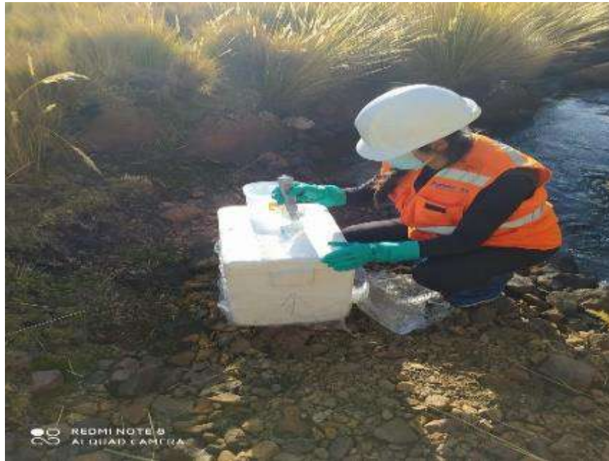
Figura 24. Toma de muestra de agua en el segundo punto M-2 Quebrada Chanquillo para determinar el pH
