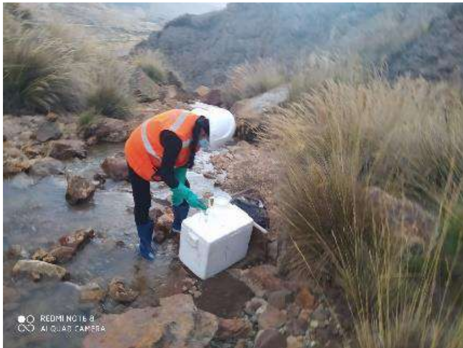
Figura 21. Se realiza la toma de muestra en el primer punto M-1 Quebrada Chanquillo par determinar el pH
