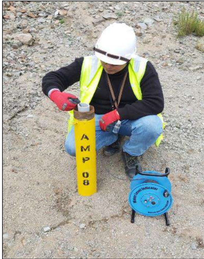
Medición de nivel freático en el piezómetro AMP-08 con la sonda piezométrica
