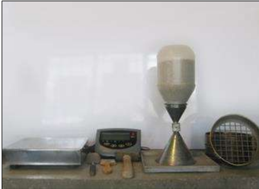
Figura 32 Equipos para el ensayo de densidad de campo
