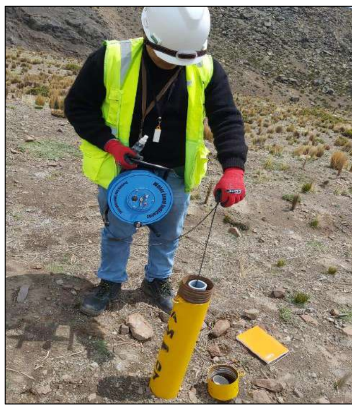
Medición de nivel freático en el piezómetro AMP-07 con la sonda piezométrica
