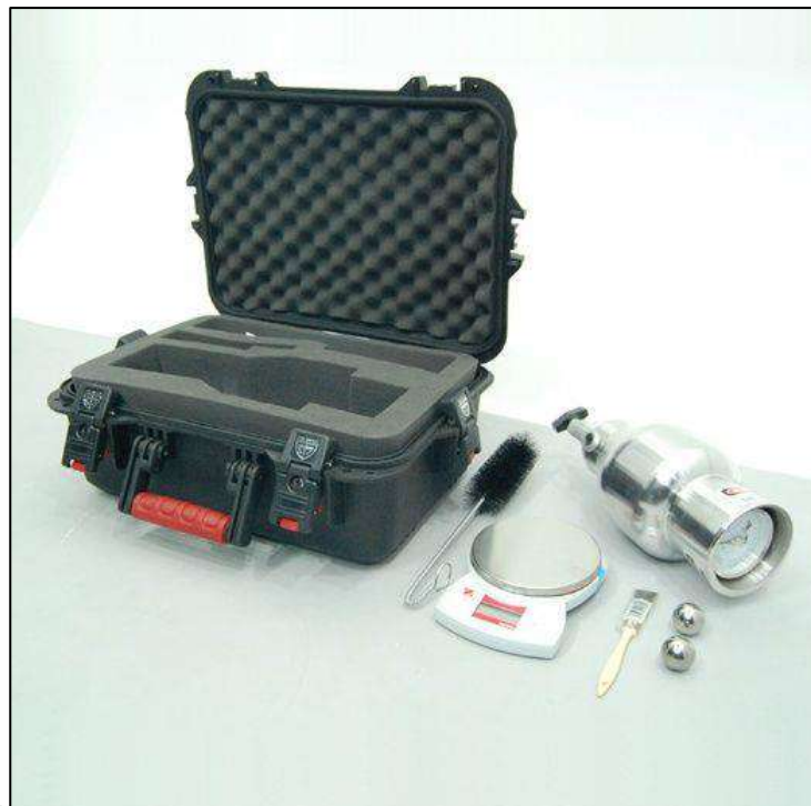
Figura 33 Equipos para el ensayo de contenido de humedad
