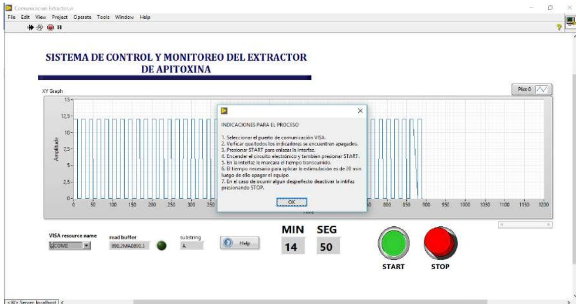
**FIGURA 9: Simulación del proceso panel de ayuda en LabView.**
