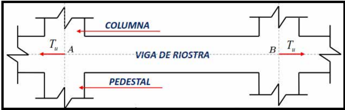
Figura 57. Análisis de viga de riostra (Tensor).
