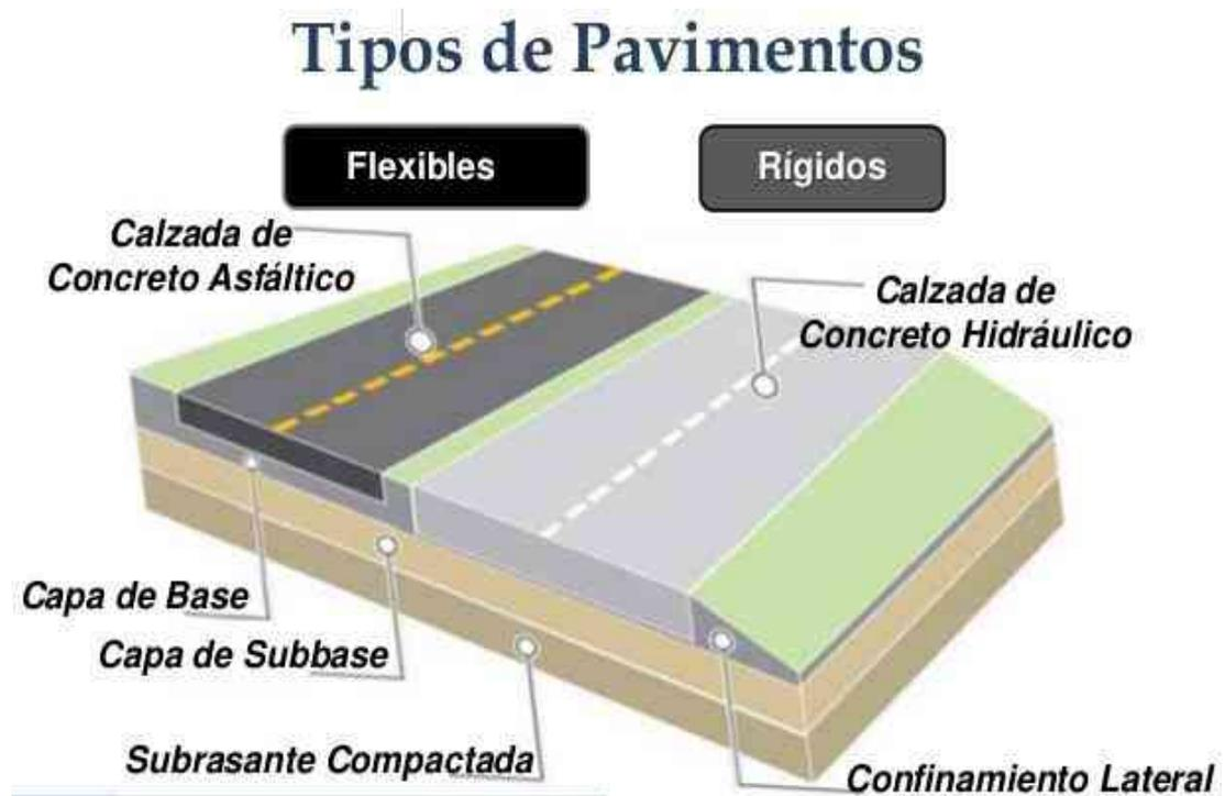
**Figura 4.** *Tipos de pavimentos*
