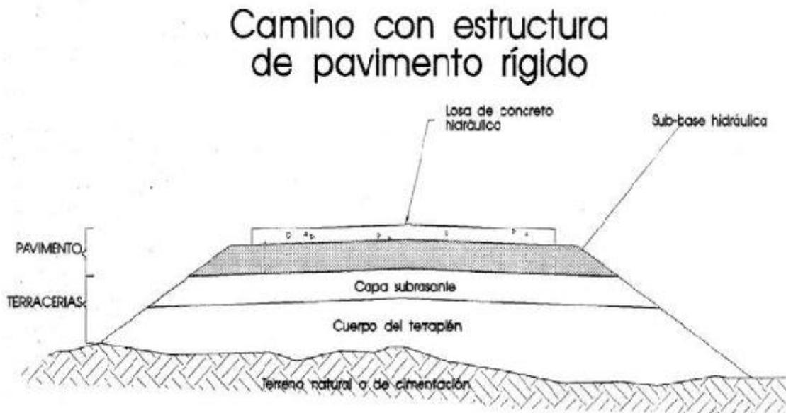
**Figura 5.** *Camino con estructura de pavimento rígido*
