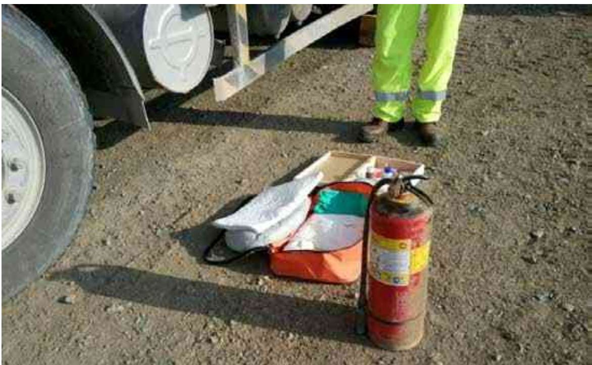
Figura 40. Inspección de botiquín y extintor de las movilidades.
