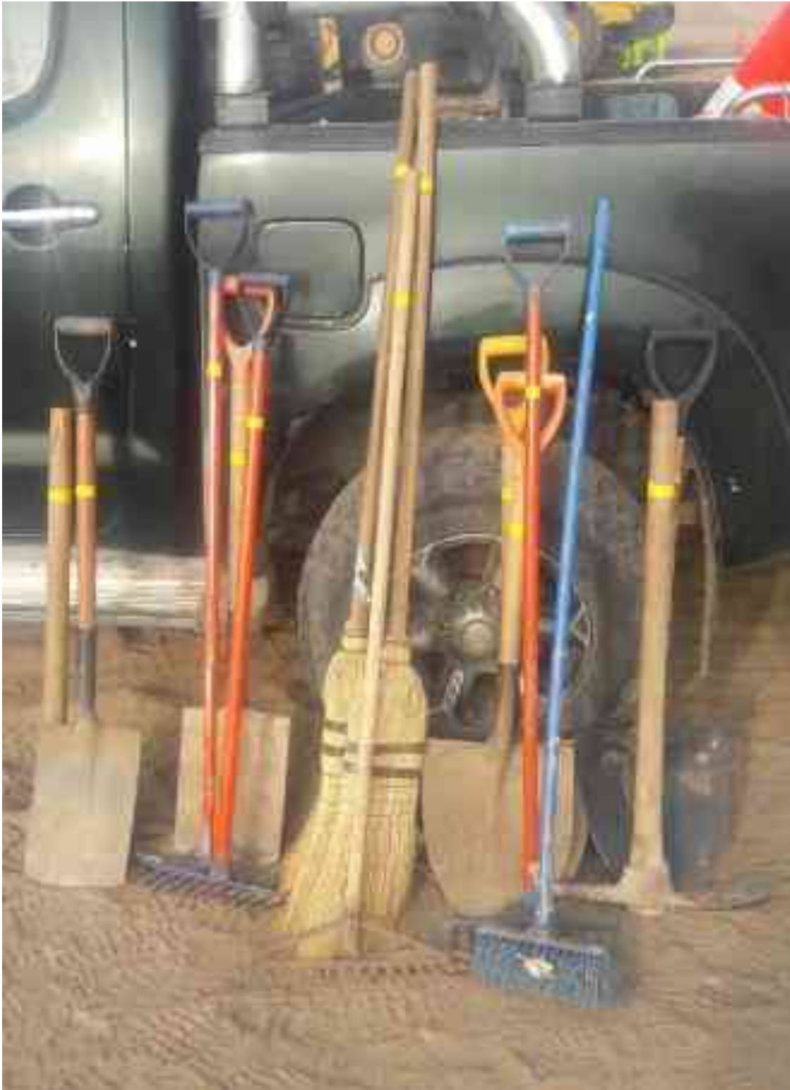
Figura 49. Colocando cinta de seguridad de color por mes para evitar herramientas hechizas
